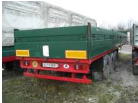
KÄSSBOHRER SB 10-22L 3-Achs-Sattelaufleger Bj. 1984 - Eigengewicht 7000 kg Länge 12850 - Breite 2550 - Höhe 3800
